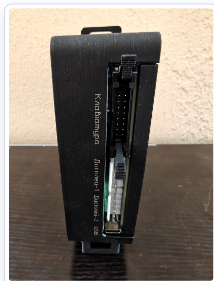
Рис. Д.9. Сторона 3 — інтерфейс оператора: Клавіатура, Дисплей-1, Дисплей-2, LCD.
