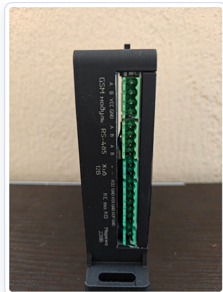
Рис. Д.7. Сторона 1 — слаботочні сигнали: GSM модуль, RS-485 (A/B), Wiegand (D0/D1), сервісні лінії.
