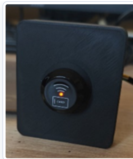
Рис. Д.3. RFID-зчитувач Wiegand у ударостійкому корпусі з LED-індикатором. Формати 26/34 біт, 3 провідники.
