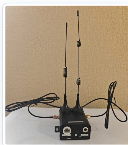
Рис. Д.5. 4G-модем Геркон (входить у комплект поставки) — LTE-модем з двома зовнішніми антенами, портом LAN, слотом SIM-картки, кнопкою Reset і живленням 12 В 1 А. Забезпечує безперебійний вихід колонки у Інтернет.
