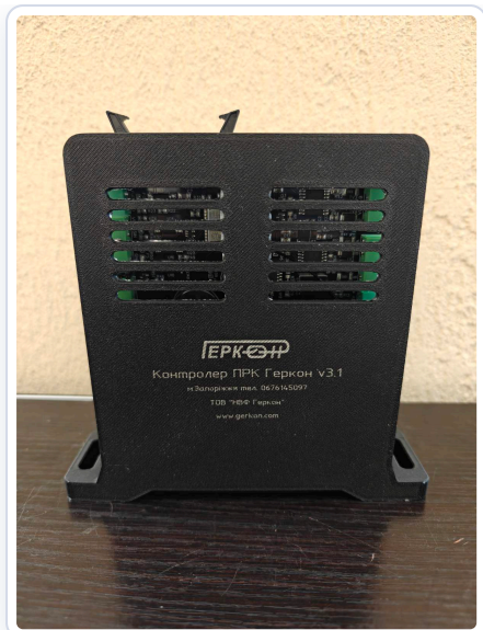
Рис. Д.6. Контролер ТРК Геркон — загальний вигляд з шильдиком, моделлю, серійним номером і перфорацією для охолодження.
