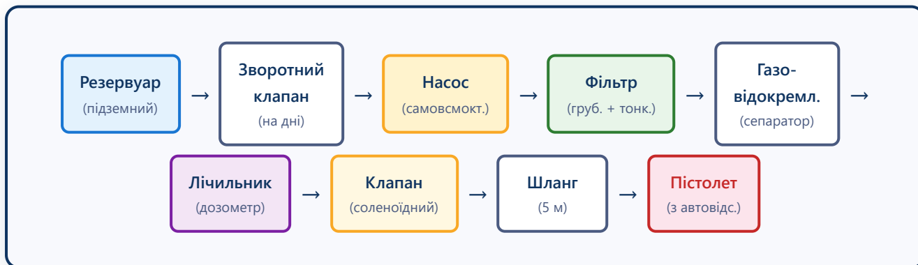
Рис. 4.1. Гідравлічна схема ПРК Геркон — послідовність проходження палива від резервуара до пістолета.
